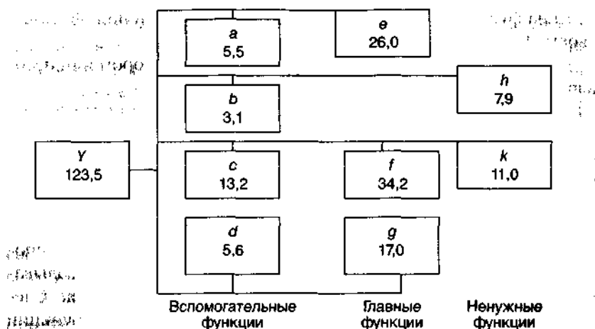
Рис. 9.2. Функционально-стоимостная модель объекта Y до анализа
